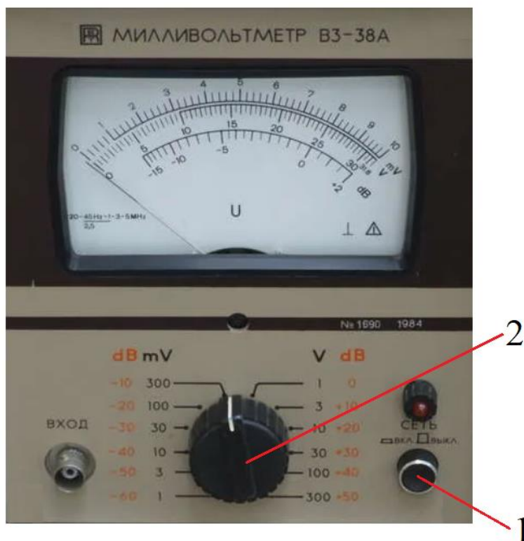
Рис. 4.5. Передняя панель милливольтметра В3-38А
